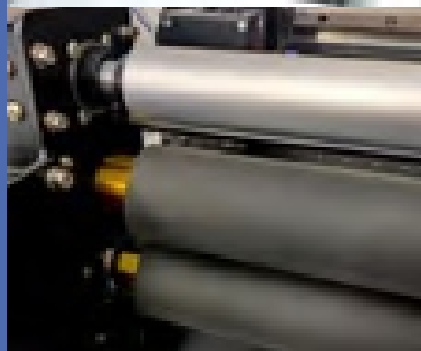
Doppio rullo riscaldato per una pressione ottimale
